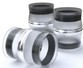
Среди новой продукции предприятия в докладе были отмечены термоусаживаемые **припоечные гильзы ГСт-Ф** – соединительные, концевые, защитные. Гильзы изготавливаются из фторполимеров и могут эксплуатироваться при температурах от  $-50$  до  $+200^{\circ}\text{C}$ . Отличительной чертой гильз является их 100% прозрачность, а также равномерный внутренний диаметр (не конусный).
